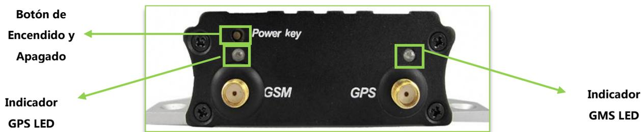
Figura 4. parte frontal de los rastreadores modelo MVT380.
