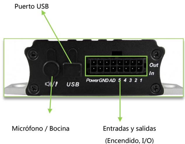
Figura 2. De izquierda a derecha Vista frontal y Reversa de los Rastreadores MVT380
