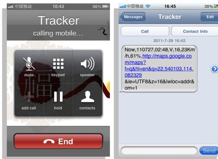
Figura 5. Mensaje SMS enviado por el rastreador a un teléfono móvil.
