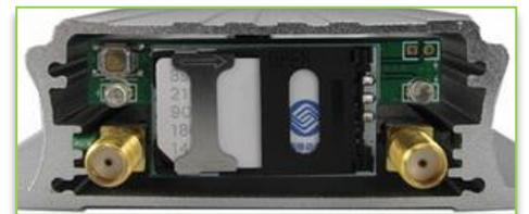
Figura 3 instalación de la tarjeta SIM.
